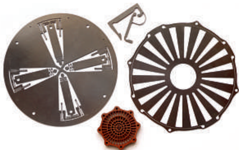
Die hohe Präzision und die universelle Anwendbarkeit des Mikrowasserstrahlschneidens werden von Anwendern zunehmend geschätzt.
