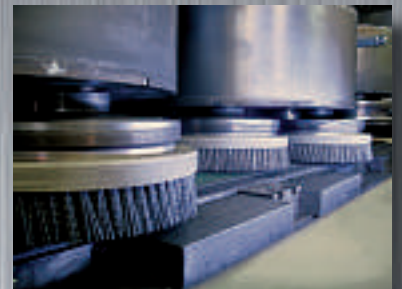
Entgraten / Polieren mit Silizium-Carbid Bürsten
