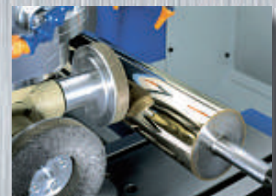
Superfinishing mit Diamant-Bürsten
